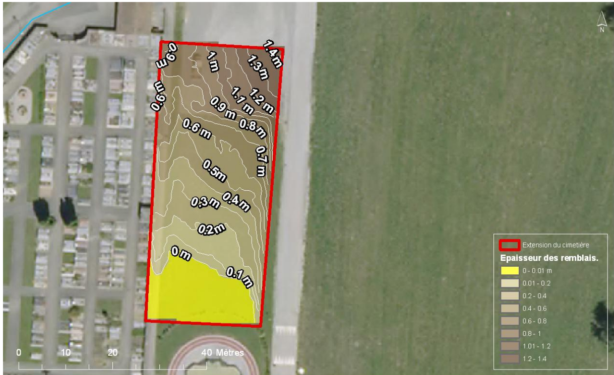
Figure 4-6 Epaisseur des remblais permettant de disposer d'une épaisseur de terrain non saturés de 3.5 mètres, pour une cote de drain situé à 680.30 m d'altitude.
