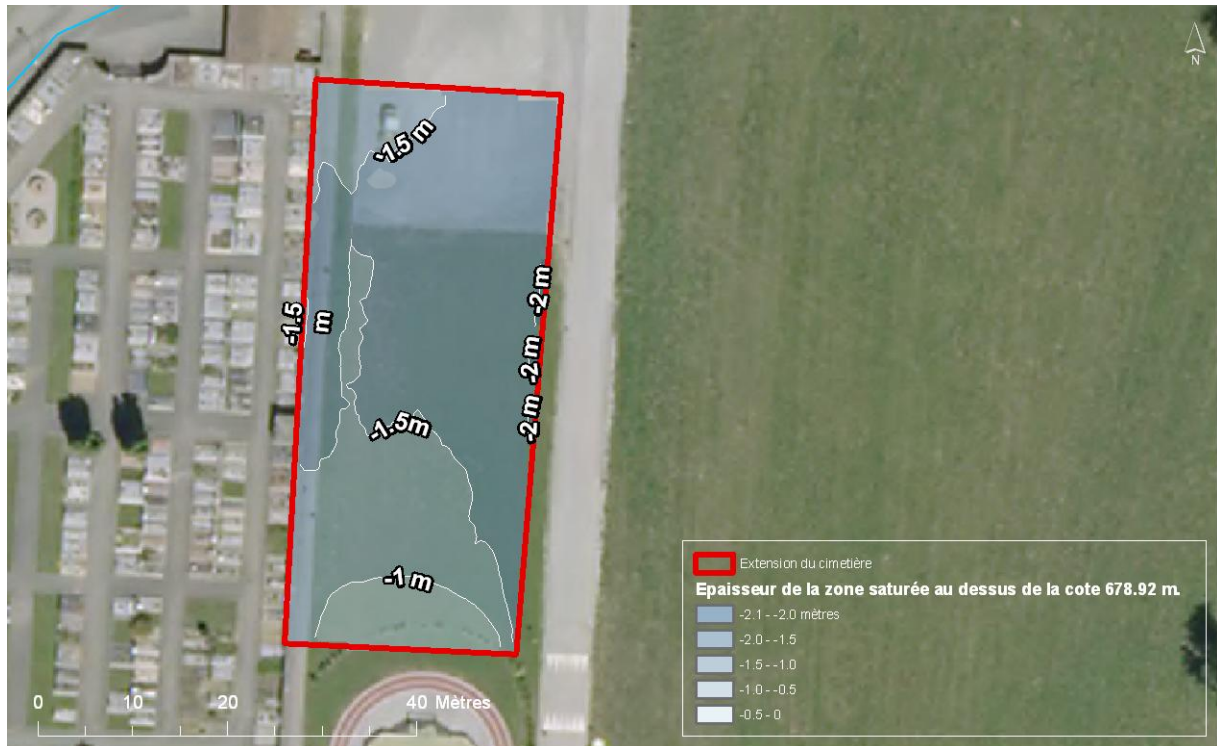
Figure 4-4. Epaisseur de terrains noyés à drainer dans l'hypothèse d'un drain localisé à la cote 678.91 m, correspondant au drainage à -3.5 m du point topographique le plus bas de l'emprise de l'extension du cimetière.
